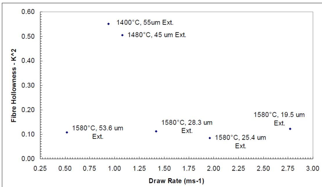
Fig.7: Correlazione tra la velocità di trafilatura (m\*s<sup>-1</sup>) e la cavità finale delle fibre (K<sup>2</sup>).
