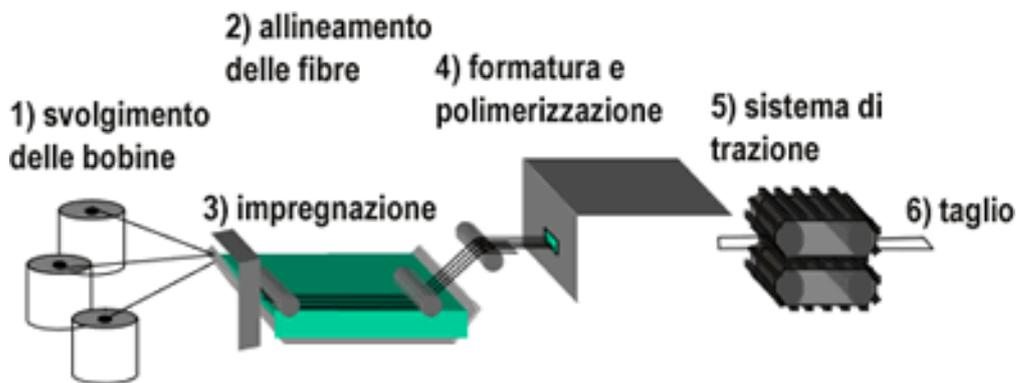
Fig.9: Processo di pultrusione
