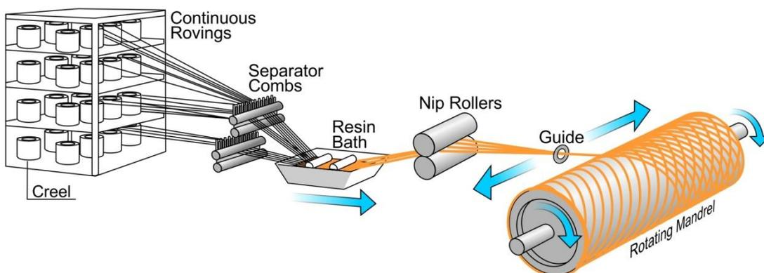
Fig.10: Processo di avvolgimento di filamenti (filament winding).
