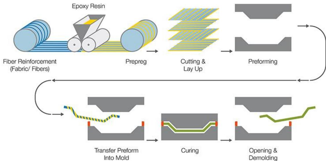
*Fig.11: Processo di formatura attraverso lamine preimpregnate (pre-preg).*
