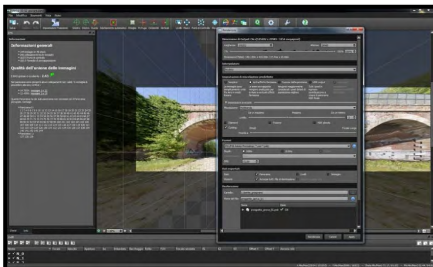
Fig. 8.12. FASE 8: L'ultimo passo consiste nell'impostare il file di output attraverso il settaggio dei parametri per il rendering (dimensione formato, miscelazioni dei colori e destinazione).
