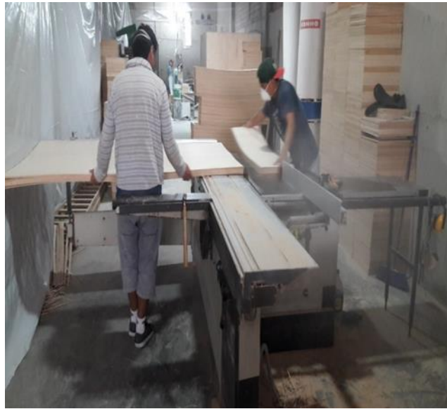
Figura 16. Cortadora de tablillas de la propuesta. Fuente: Elaboración propia (2020)
