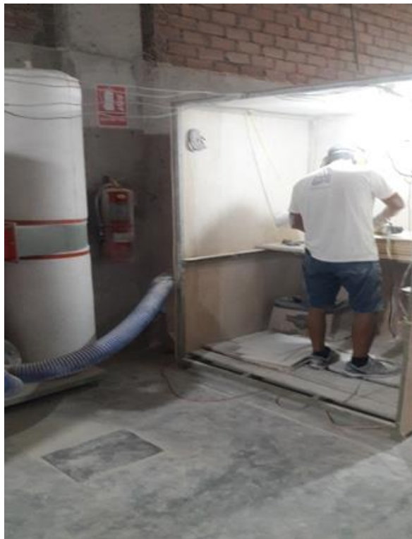
Figura 26. Área de lijado propuesta (nueva) con cabina en el proceso de fabricación de rompecabezas. Fuente: Elaboración propia (2020)
