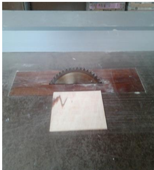
Figura 15. Sierra de corte giratoria para el corte de tablillas.
