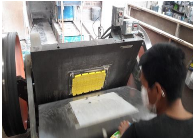
Figura 23. Área de troquelado antigua en el proceso de fabricación de rompecabezas. Fuente: Elaboración propia (2020)
