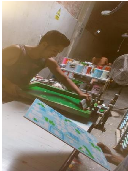
Figura 19. Área de estampado utilizada anteriormente en el proceso de fabricación de rompecabezas. Fuente: Elaboración propia (2020)
