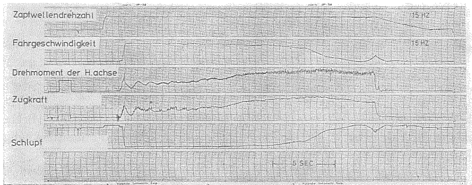
Bild 6. Zapfwellen-Drehzahl, Fahrgeschwindigkeit, Drehmoment der Hinterachse, Zugkraft und Schlupf in Abhängigkeit von der Zeit auf wellenf reier Betonstraße.
