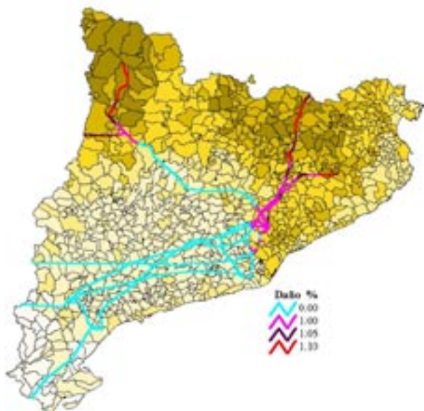
Figura 5: Dany esperat en les línies de transmissió elèctrica de 400 kV.
