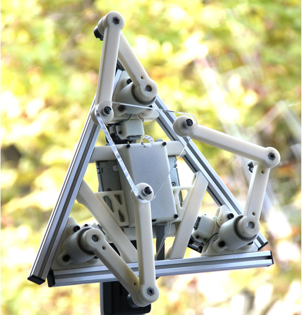
Figura 1.1: El robot 3-RRR construido.
