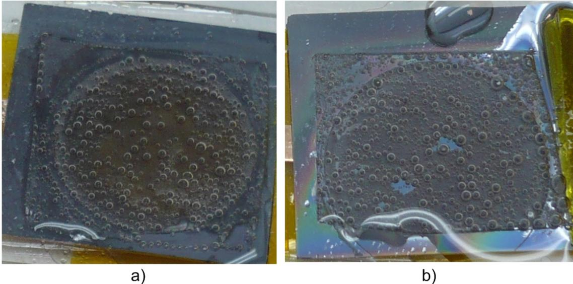
**Fig. 3.19.** Dos muestras con PDMS, atacadas con KOH en la superficie frontal. a) Estructura 3D con membrana en la cara posterior. b) Estructura 2D sin membrana en la cara posterior. En ambos casos, la capa de PDMS que queda en la superficie limita la zona en la que el KOH ataca al silicio. Las burbujas son el resultado del ataque.
