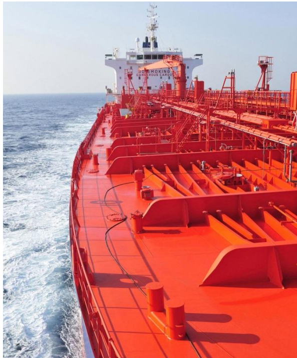
· Imatge 3: Vaixell químic amb el detall de la coberta plena de reforços transversal.
