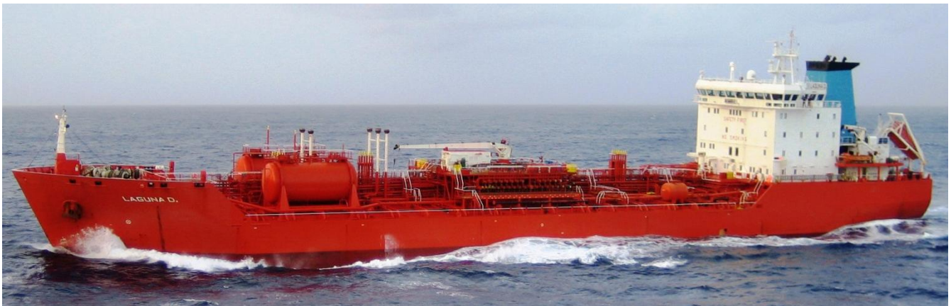
· Imatge 4: Vaixell químic amb el detall dels tancs amb additius pel control de la càrrega a proa.
