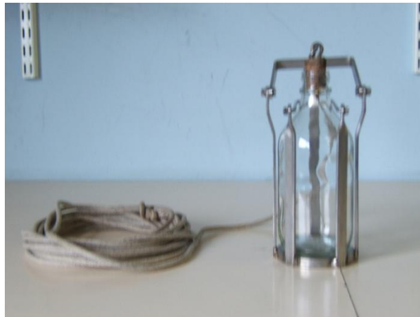
· Imatge 25: Recipient contenidor integrat en l'aparell mostrejador.
