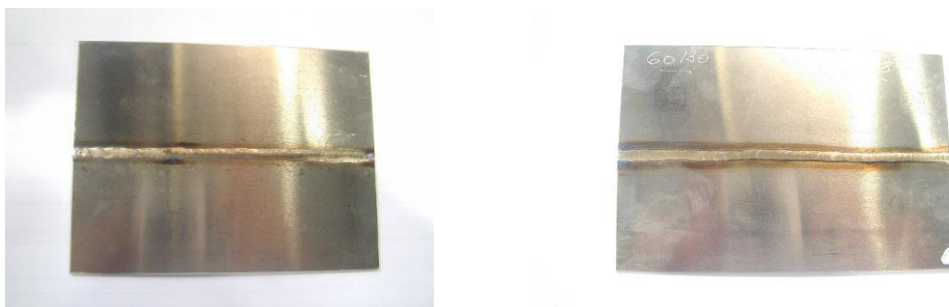
Figura 33: Probeta soldada para la calificación del soldador en el grupo IIIb (material base INCONEL 718)
