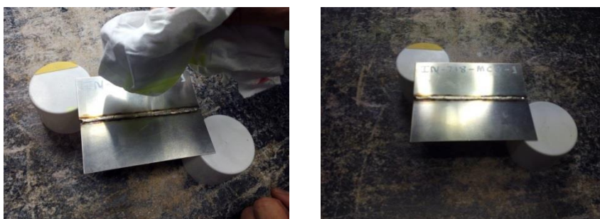
Figura 36: Remoción del penetrante con un paño limpio mojado en eliminador.
