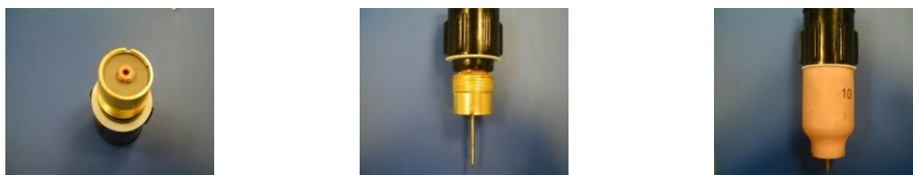
Figura 17: Ejemplo del montaje de una antorcha con difusor de gas
