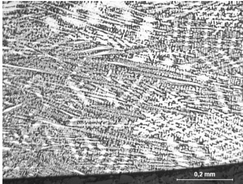
Figura 45: Cordón de soldadura(x100). Zona 1-A de la Figura 44.
