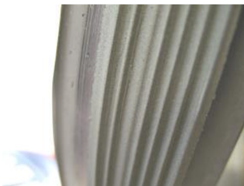
Figura 87: Aspecto de las cuchillas recubiertas con Metco 81 VFNS
