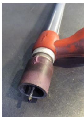
Figura 52: Electrodo EWP con la punta redondeada tras soldar con CA.
