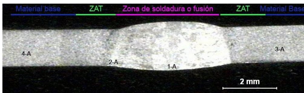
Figura 44: Fotografía de la sección transversal de la probeta soldada e identificación de las diferentes zonas con las que cuenta un cordón de soldadura (zona de soldadura o fusión, zona afectada por la temperatura ZAT y el material base).
