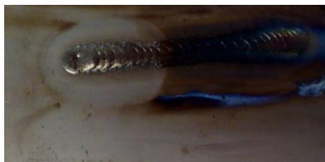
Figura 53: Ejemplo de un cordón de soldadura de titanio con una zona con decoloración y otra parte del cordón bien protegida
