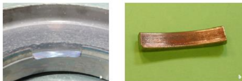
Figura 69: Probeta obtenida del diámetro interior del cierre de cuchillas.
