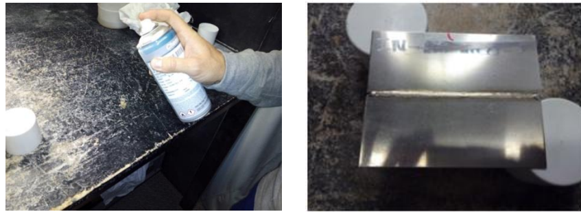
Figura 37: Aplicación del revelador en spray.
