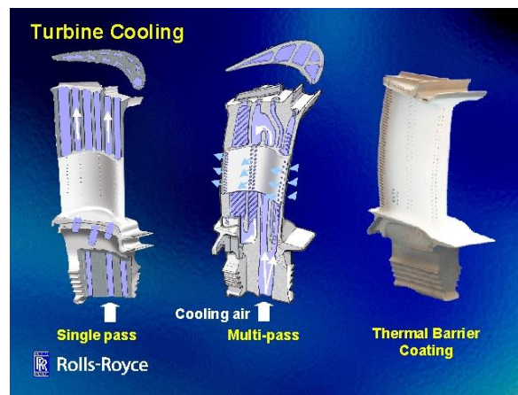
Figura 10: Evolución de la refrigeración y aplicación de TBC en álabes de turbina.
