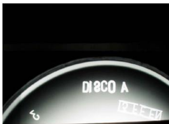
Figura 67: Ejemplo de una radiografía de un cierre. Se demuestra que es una técnica no apta para la inspección de cuchillas.
