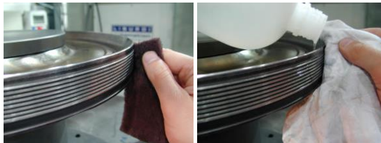
Figura 60. Remoción de óxidos y limpieza de las cuchillas antes de soldar con a) Scotch Britte y b) acetona.
