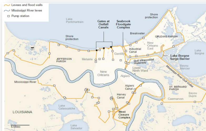
Image 113. Améliorations sur les chenaux et les digues de la Nouvelle Orléans
