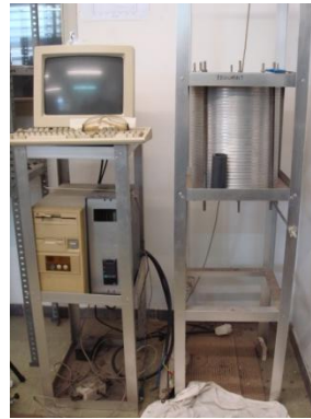
Figura 4.12 Horno vertical tipo Bridgman usado para obtener semillas de NdBCO en el PFC.
