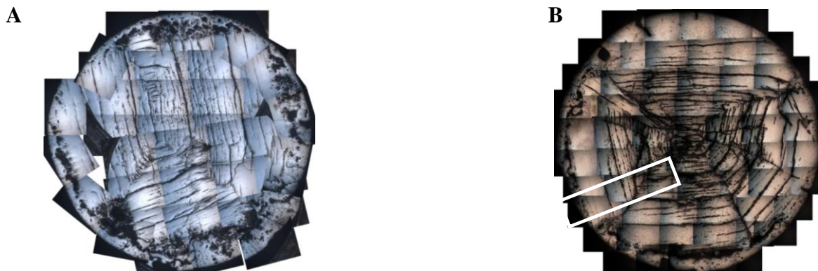
Figura 7.21 MO de la superficie pulida de las muestras con T1, T2 y Ve de 1.010, 1.005 °C y 0,2 °C/h. Muestra A) y B).
