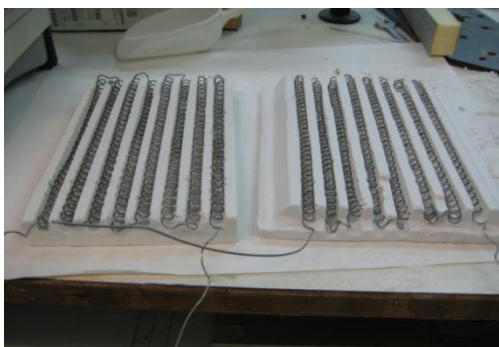
Figura 6.14 Hilo de Kanthal® bobinado y situado en las ranuras troqueladas de las dos placas grandes
