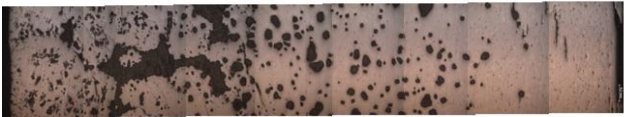
Figura 7.11 Sección transversal de la muestra con T1, T2 y V e de 1.015, 1.005 °C y 0,2 °C/h. Se observa un aumento del número de burbujas conforme nos alejamos de la semilla.
