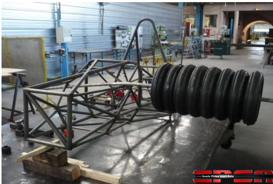
FIGURE 31 – Test de rigidité en torsion du système châssis équipé sur banc
