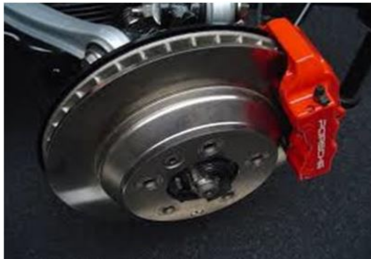
FIGURE 20 – Exemple de système de freinage à disque
