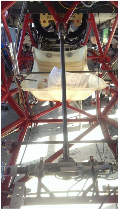
FIGURE 40 – Système de direction intégré sur Atomix, photo 1
