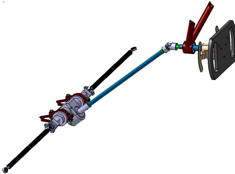
FIGURE 32 – Modélisation numérique du système de direction
