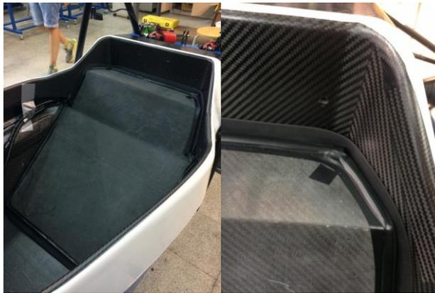
*Fig. 6.3 a) Tapa-respaldo del asiento y b) detalle de la goma estanca (Fuente propia)*
