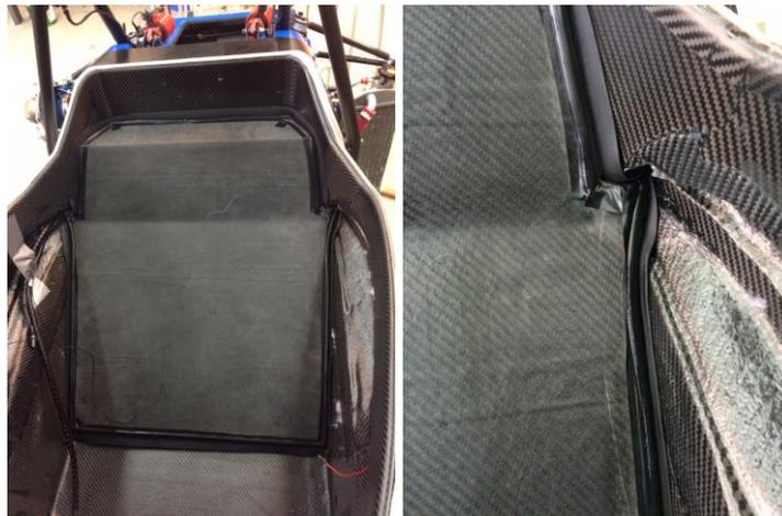
Fig 6.12 a) Canales a ambos lados y b) detalle del paso por el respaldo (Fuente propia)
