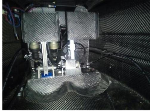
*Fig. 5.14 a) Render pedalería (Fuente: Robert Armengol, ETSEIB Motorsport) y b) foto de la misma instalada en el monocasco (Fuente propia)*
