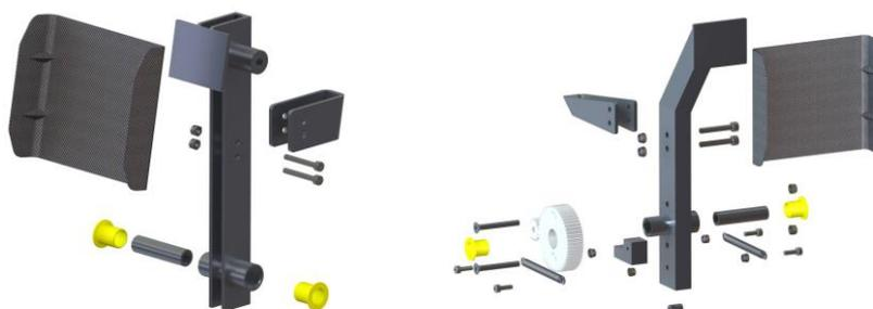
*Fig. 5.13 Render explosionado pedal de freno a) y acelerador b) (Fuente: Robert Armengol, ETSEIB Motorsport)*
