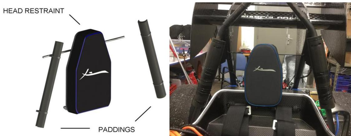
Fig 6.9 Reposacabezas CAT08e, render a) y fotografía b) (Fuente propia)
