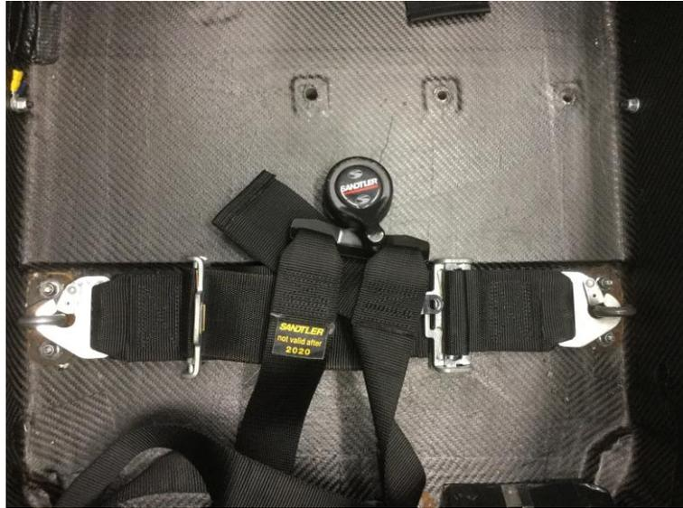
*Fig. 6.5 Detalle de los cinturones con los anclajes de los lap belts (Fuente propia)*
