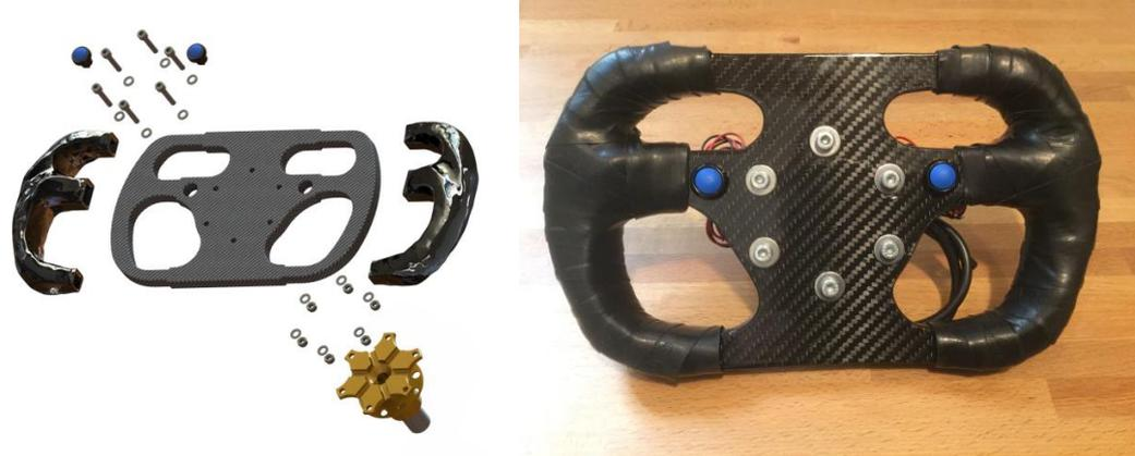
Fig. 5.8 a) Render del volante explosionado, b) Volante acabado (Fuente propia)
