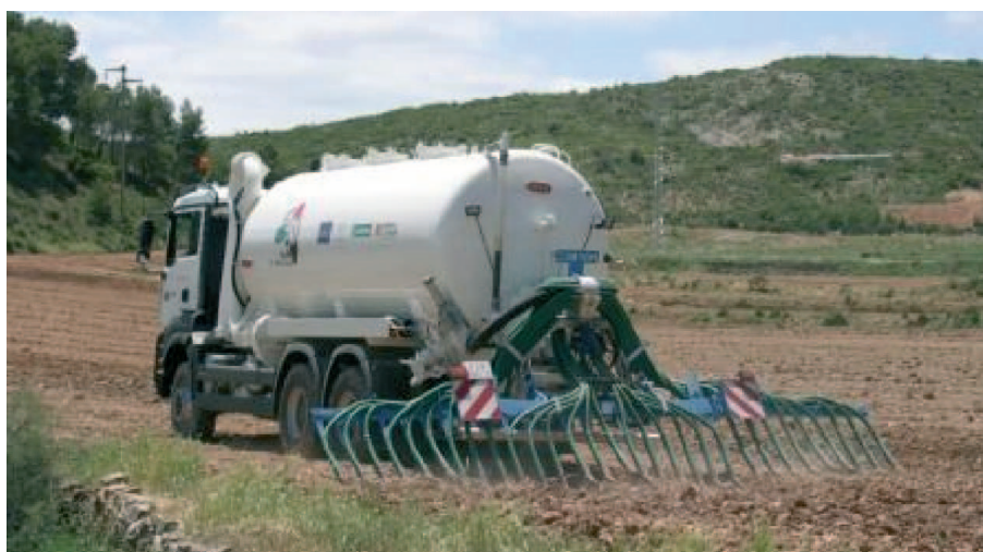
Imagen 1. Equipo de transporte y aplicación del purín.
