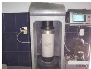
Imagen 1.3.2.1- Medición de la resistencia
