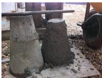
Imagen 1.3.2.1- Medición de la consistencia
