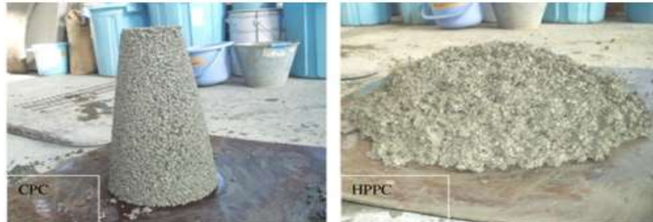
Figura 2.7. Comparación entre el cono y la fluencia de un hormigón poroso convencional (CPC) y un hormigón poroso de propiedades mejoradas (HPPC) (Bhutta et al. - 2011).
