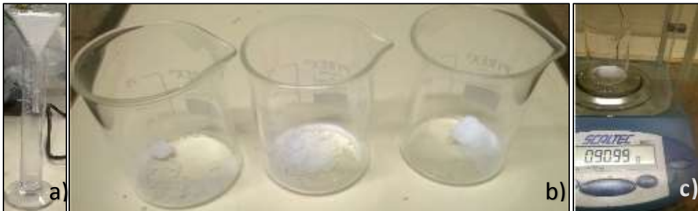
Figura 3. 9. Proceso de ensayo para determinar la cinética de disolución de las muestras (en el caso de la urea), a) filtrada, b) secada, c) pesada.
