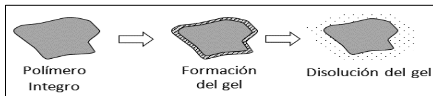
Figura 3. 16. Esquema de funcionamiento del árido parcialmente soluble
