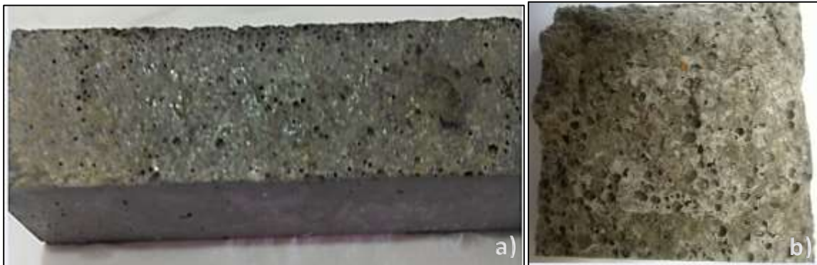
Figura 4. 11. Probeta de mortero con urea a edad de 5 días, a) superficie de la probeta, b) interior de la probeta
