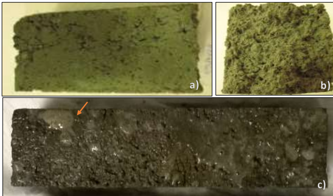
Figura 4. 21. Aspecto de mortero con Esacol HS 30 R y Melmix (EM). a) Superficie de la probeta luego del desmolde a edad de 2 días, b) Interior de las probetas, c) probeta luego de 5 días en la cámara húmeda.
