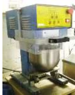
Figura 3. 10. Amasadora utilizada para la preparación de los morteros.
