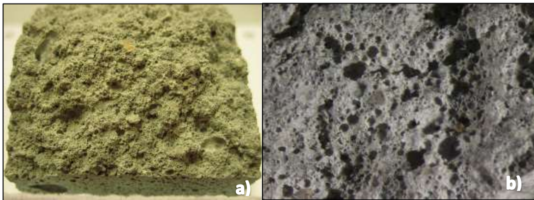
Figura 4.16. Estructura del mortero aditivado con Melmix, a) aspecto de la probeta, b) vista microscópica.
