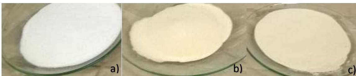
Figura 3. 17. Aspecto visual de los polisacáridos en polvo, a) Special Starch 6007, b) Esacol HS 30 R, c) Lamsize 5300.
