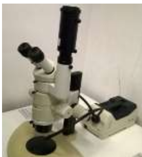
Figura 3. 13. Microscopio utilizado para evaluar la estructura de los morteros con aire ocluido
