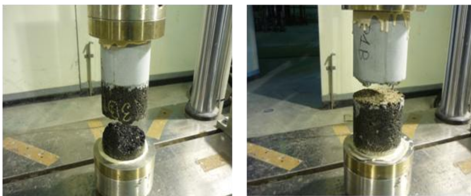
Figura 4.3 Ensayo Pull-out junta sin tratamiento (a). Ensayo Pull-out junta abujardada (b)
