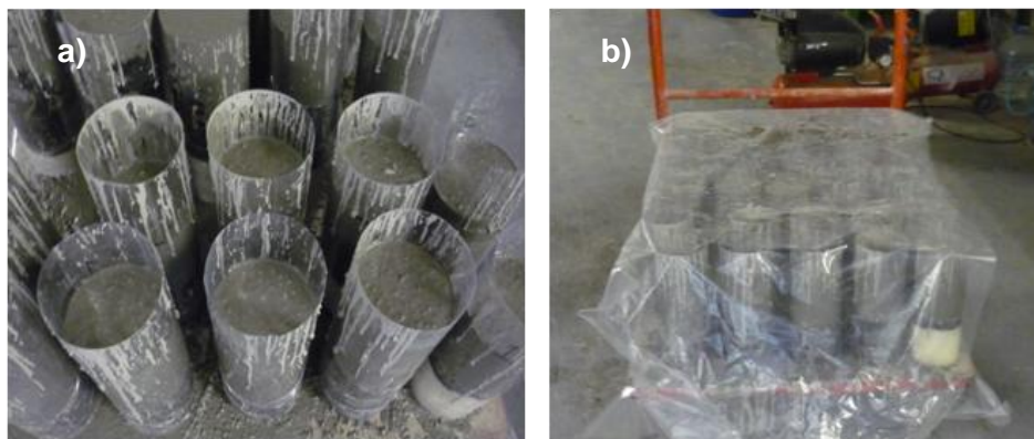
Figura 3.11 Probetas hormigonadas (a), Conservación durante las primeras 24 horas (b).
