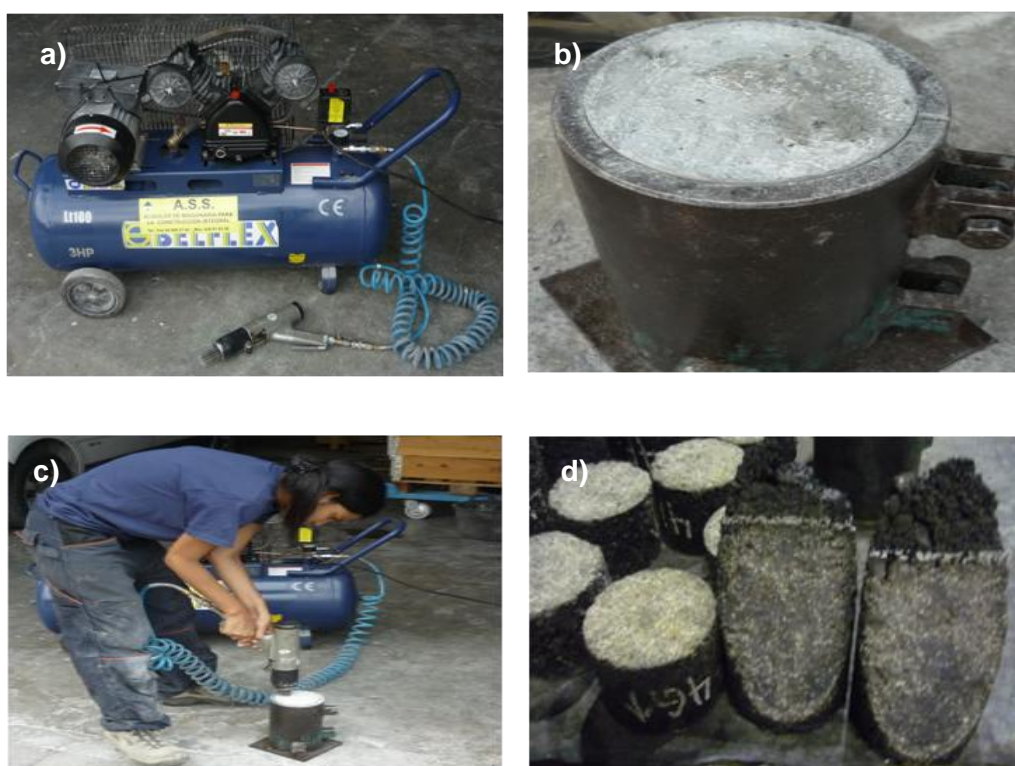
Figura 3.6 Maquina de pistola de agujas (a), Fijación de probeta en molde metálico (b), Abujardado de la semi-probeta asfáltica (c), Probetas abujardadas (d).
