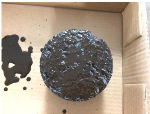
Figura 3.7 Técnica de emulsión asfáltica ECR1
