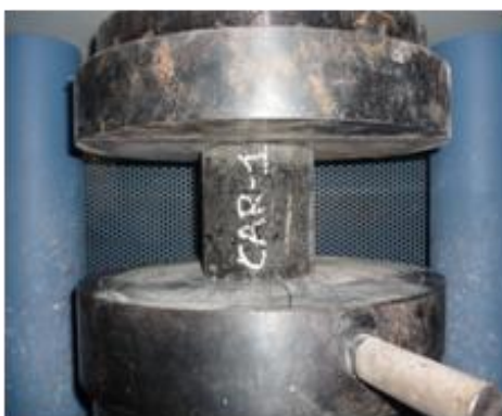
Figura 3.19 Ensayo a Compresión.
