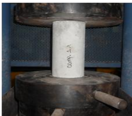
Figura 3.21 Ensayo a Compresión simple del Hormigón.
