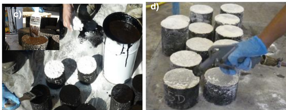
Figura 3.9 Removido del producto mediante a un taladro de bajas revoluciones (a), Limpieza de la superficie (b), Aplicación del producto + polvo (c), extracción del polvo sobrante mediante a compresor (d).
