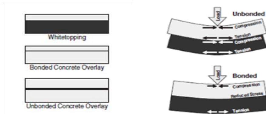
Figura 2.2 Tipos de Recubrimientos(a). Efecto de la acción compuesta del comportamiento de UTW Y TWT cargado bajo a flexión (b). Fuente:(Boardman et al., 2004)
