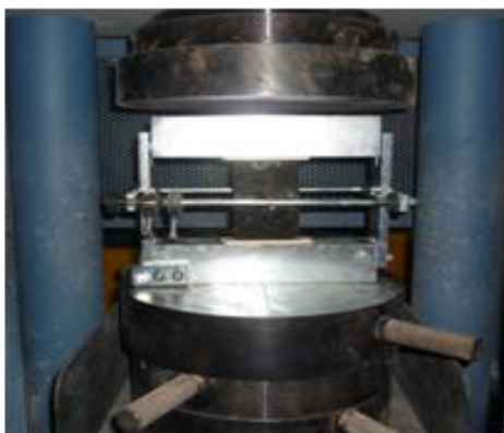
Figura 3.18 Ensayo a Tracción Indirecta.
