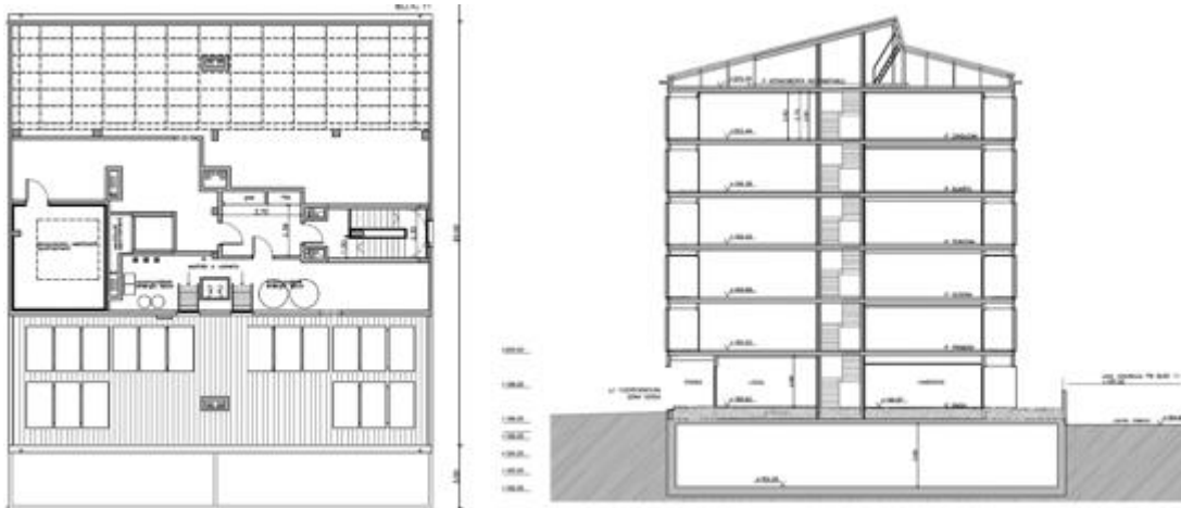
Figura 3.8 Vista de planta de la cubierta y sección transversal del edificio se puede observar el techo a dos aguas.
