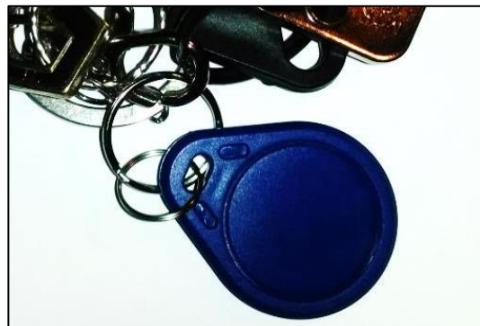
Fig. 7.38 – RFID tag, in a convenient keychain package.
