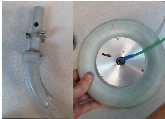
Figura 50: Motor hub i forquilla rebudes de la FIB
