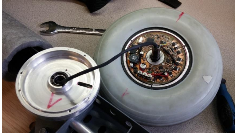
Figura 58 Detall d'un dels motors amb el cablejat protegit
