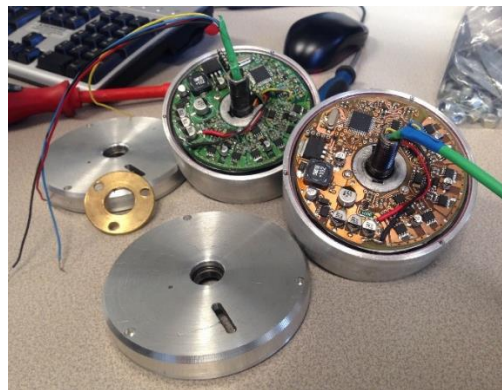
Figura 56 Estat inicial del cablejat dels motors
