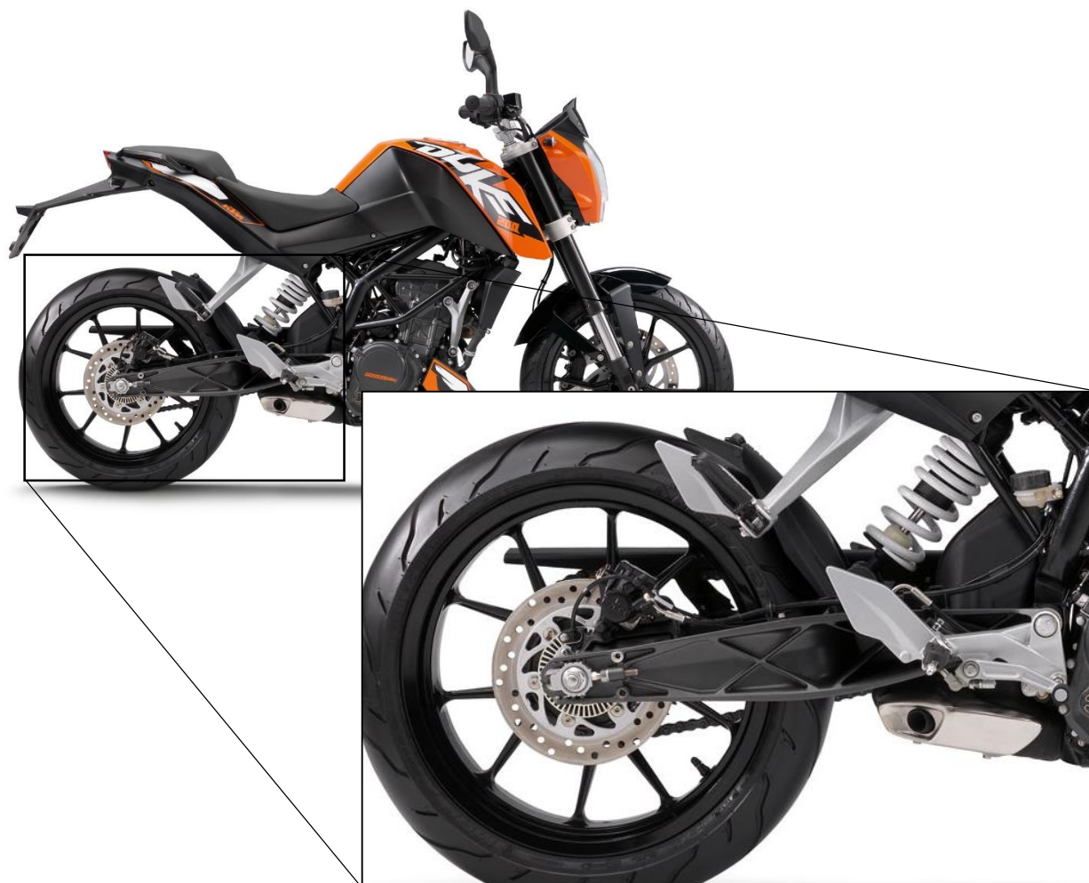
Figura 225: Estructura nervada del basculant de la KTM Duke
