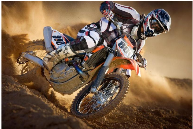
Figura 306: El parafang recull part de la terra que llença la roda
