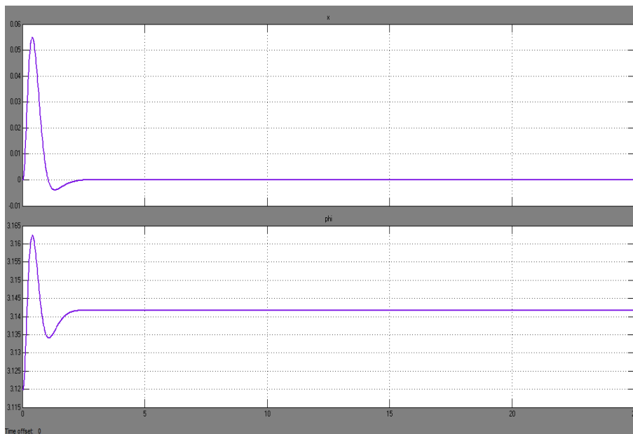
Figura 30 Resultat de la simulació aplicant una condició inicial x_3=3,12 rad sobre el sistema enllaç tancat no lineal discret amb retard
