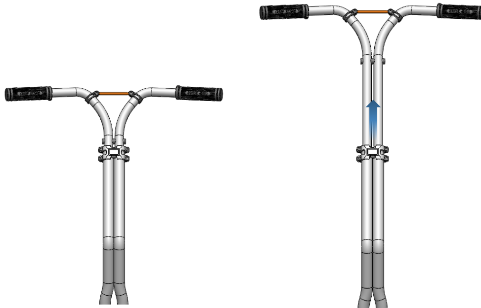
Figura 295: Posició mínima i màxima del manillar
