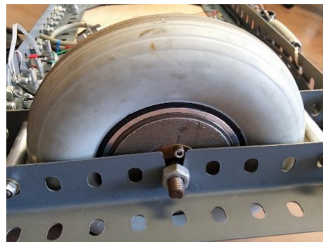
Figura 60 Fixació roda, costat rosca mètrica
