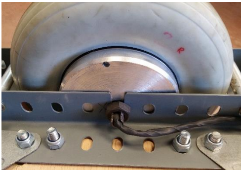
Figura 59 Fixació roda, costat cable
