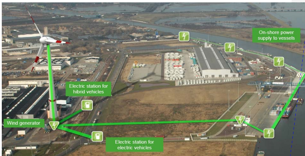
Figure 2: Eolic energy system in Magdeburg Port. FMD Flugdienst Magdebur GmbH (Kluge, 2012).
