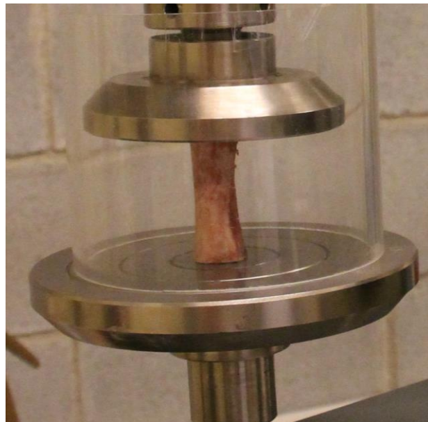
Figura 4.19. Preparación del ensayo de compresión sobre tibia de cerdo.
