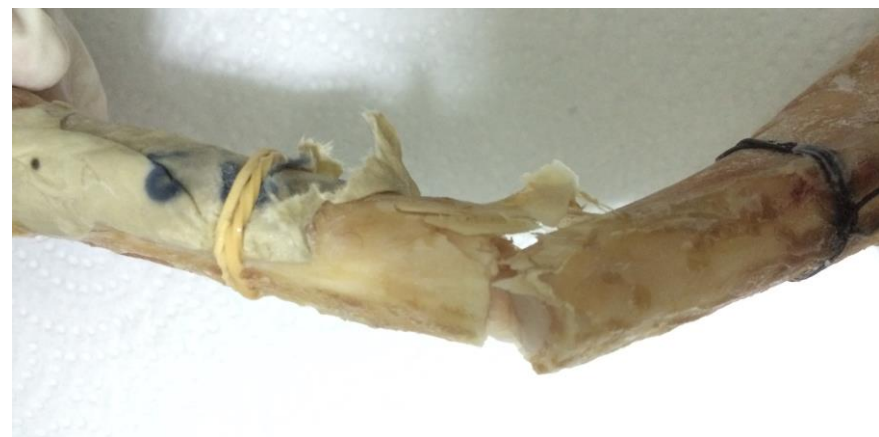
Figura 5.3. Resultado del ensayo a flexión en tres puntos para tibia 3
