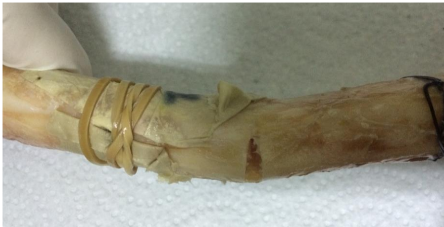
Figura 5.2. Resultado del ensayo a flexión en tres puntos para tibia 2
