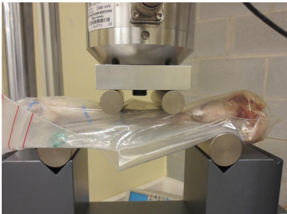
Figura 4.16. Aplicación de la precarga sobre la muestra antes de iniciar el ensayo.
