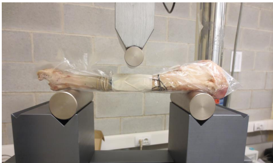
Figura 4.13. Colocación y sujeción de la muestra para ensayo a flexión en 3 puntos.
