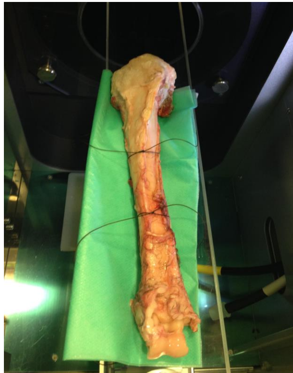
Figura 4.6. Muestra de tibia de oveja en soporte de MicroCT.
