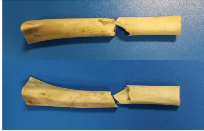
Figura 5.4. Resultado ensayo a flexión en tres puntos para fémur 1.
