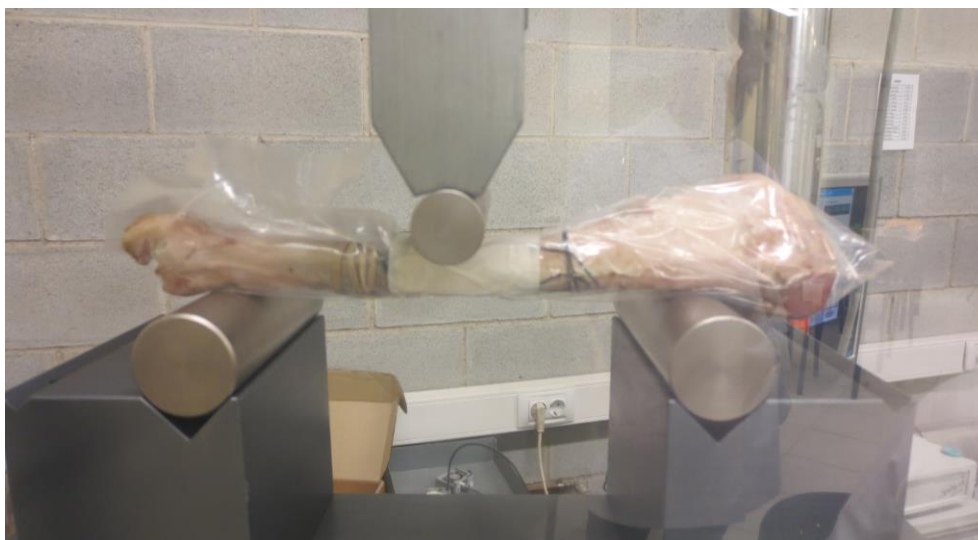
Figura 4.14. Aplicación de la precarga sobre la muestra antes de iniciar el ensayo.
