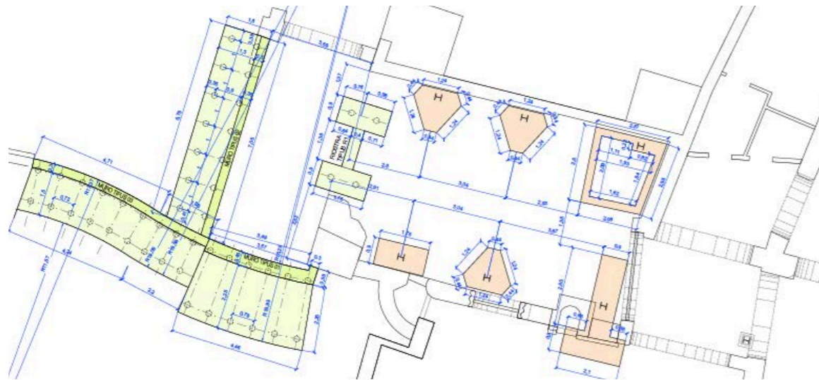
Figura 49: Proposta d'execució dels micropilons per a la consolidació del nou mur de contenció de terres (Font: VOLUM I: Memòria, Annexes i Plànols – 4ª Fase)
