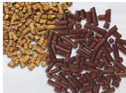
Imagen 2.6.5. Diferentes tipos de pellets para la utilización como combustible en una caldera de biomasa.
