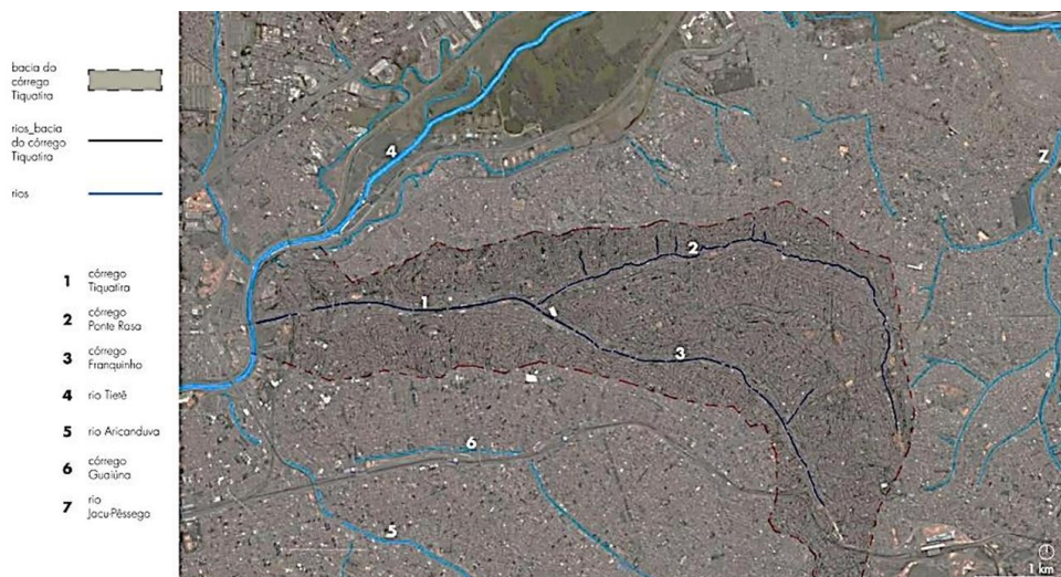
Gráfico 5: Foto aérea do córrego Tiquatira: rede hídrica e área da bacia hidrográfica
