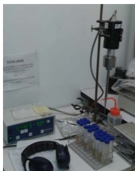
Fig. 5.8 Equipo de ultrasonido para disgregar las matrices de fibras coaxiales cargadas con bacterias
