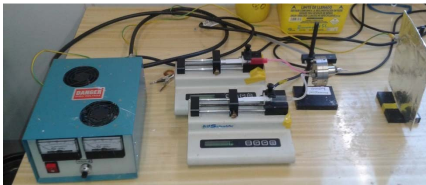
Fig. 5.1 Esquema del equipo de electrospinning coaxial
