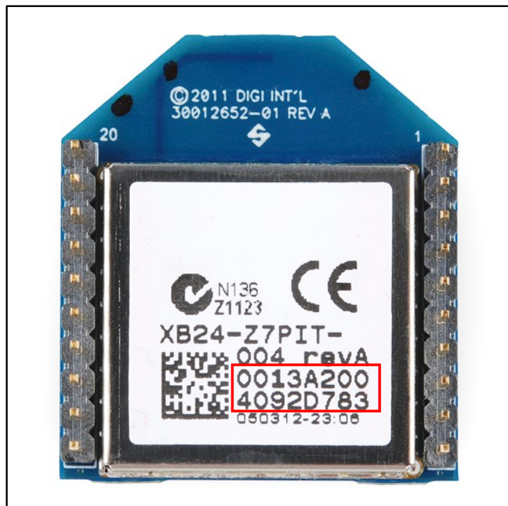
Figura 10. Detall adreça Mac mòdul XBee.
