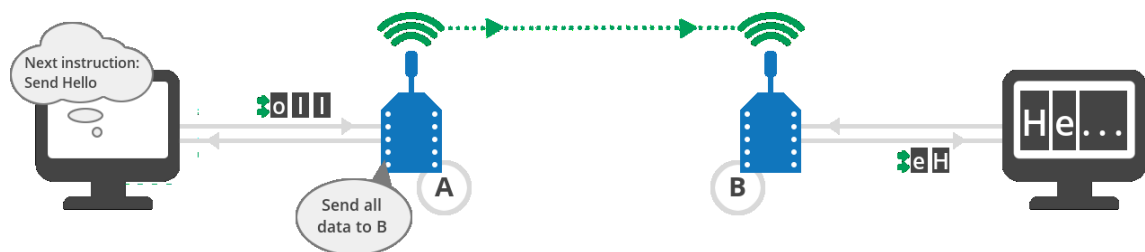
Figura 20. Comunicació transparent entre mòduls XBee.
