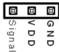
Figura 30. Distribució dels pins d'una entrada analògica.
