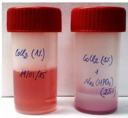
Fig. 4.6 Dissolució aquosa a l'1% en pes de Co i dissolució a l'1% en pes de Co amb accelerant.
