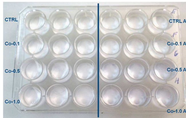
Fig. 4.11 Discs de ciment submergits en aigua (3 discs per cadascun dels 8 tipus de mostra)
