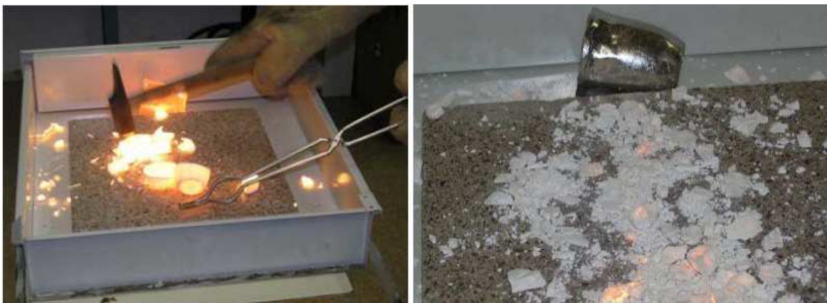
Fig. 4.2 Tremp a l'aire d' \alpha -TCP
