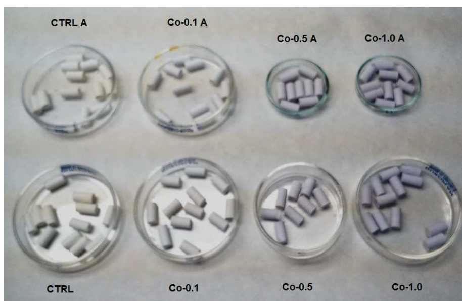
Fig. 4.9 Provetes assecades i ordenades per tipus de mostra. Les mostres al 0.1%, 0.5% i 1% en pes de cobalt presenten una seqüència gradual de color
