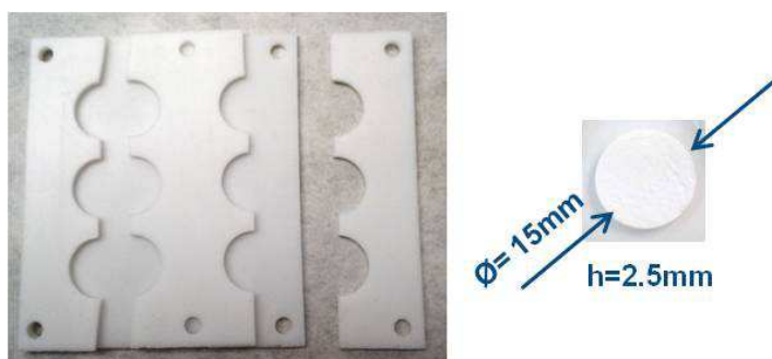
Fig. 4.10 Motlle de tefló de fàcil obertura amb cavitats cilíndriques ( \varnothing=15\text{mm} i h=2.5\text{mm} )
