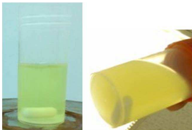
Fig. 6.9 Reactiu ATP-MB-Cu 2+ sense precipitats, a l'instant final de la seva preparació i el mateix reactiu amb precipitats, després de 2 minuts.
