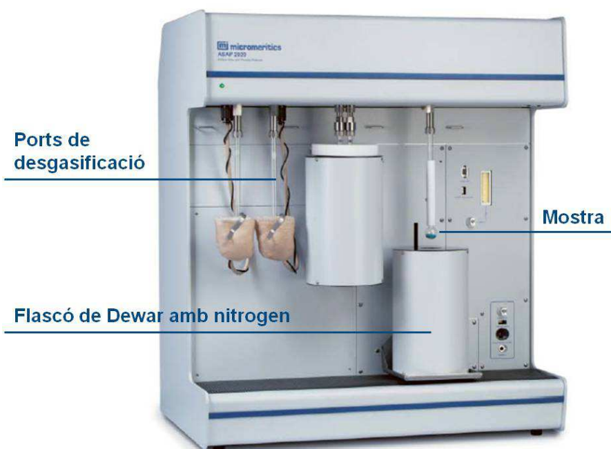
Fig. 5.5 Esquema de l'aparell de flux dinàmic Asap 2020, Micromeritics usat en la desgasificació i l'assaig d'adsorció física de nitrogen
