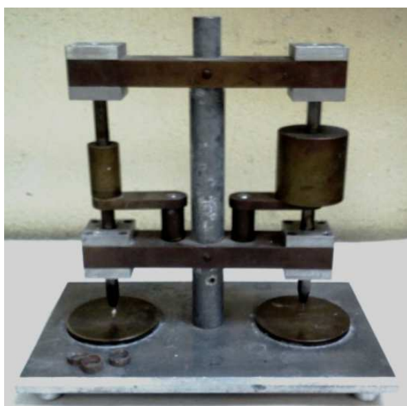
Fig. 5.1 Agulles de Gillmore utilitzades en la determinació del temps de presa
