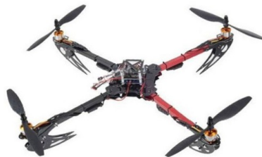
FIGURA 1.3: Multirrotor de 4 motors, també anomenat quadcopter 5 .
