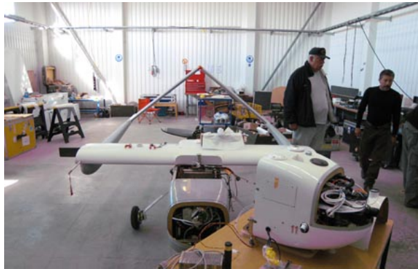
FIGURA 4.5: Model SIERRA amb el compartiment de càrrega desmuntat 5 .
