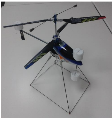
Figura 18: Foto de l'helicòpter amb les modificacions finals.
