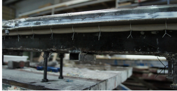
Figura 3.4: Fixació elàstica dels nuclis.
