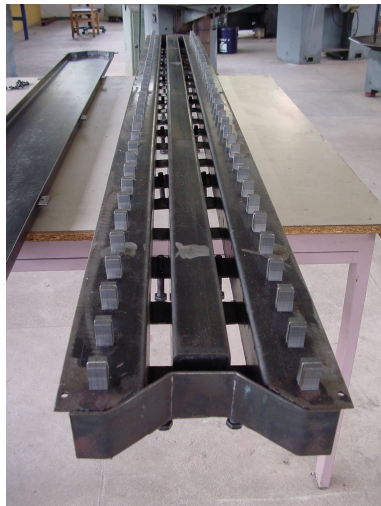
Figura 3.2: Disposició dels nuclis dins del motllo.
