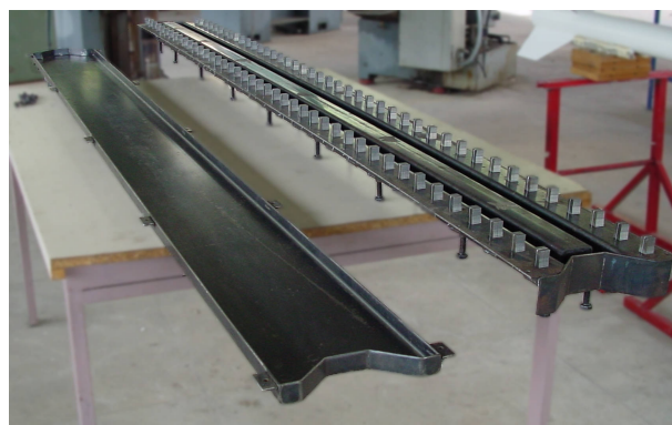
Figura 3.3: Motllo amb els nuclis abans de posar la tapa.
