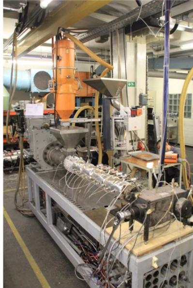
**Bild 29** Aufbau des HELIBAR® Soplar Extruders.
