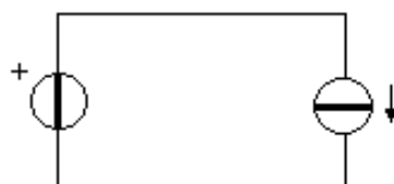
Figura 8. Convertidor tensió-corrent amb únic sentit d'enllaç.
