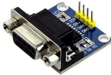
Figura 11. Conversor RS-232 TTL
