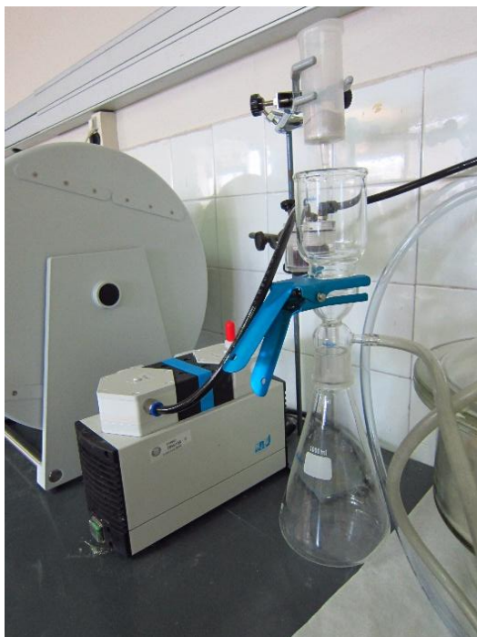
Figura 7.26 Muntatge del sistema de filtració
