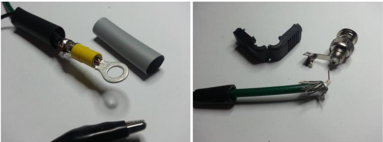
Fig. 3.5: Fotos de las terminaciones del cable de conexión máquina-placa de pruebas.
