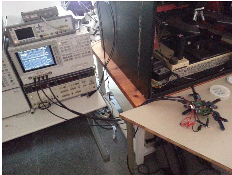
Fig. 4.3: Foto de máquina de medición Agilent 4294A realizando mediciones.
