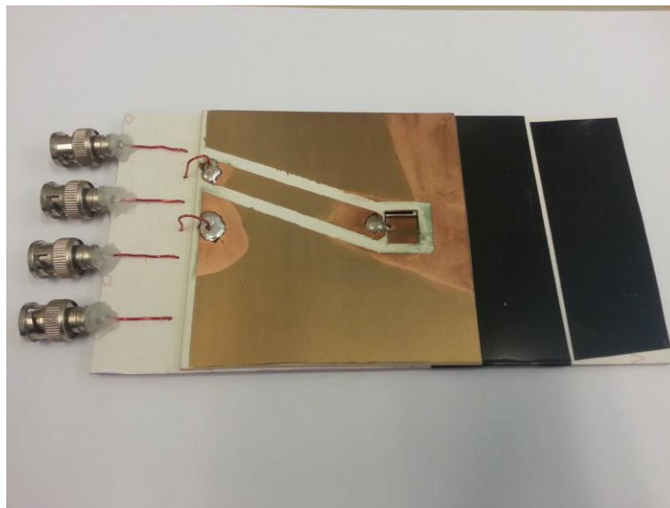
Fig. 3.3: Placa prototipo de conexión directa a máquina de medición.
