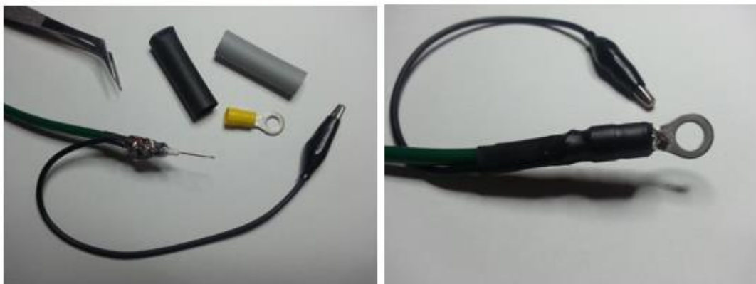
Fig. 8.15: Fotos montaje de extremo terminación de cable de conexión.
