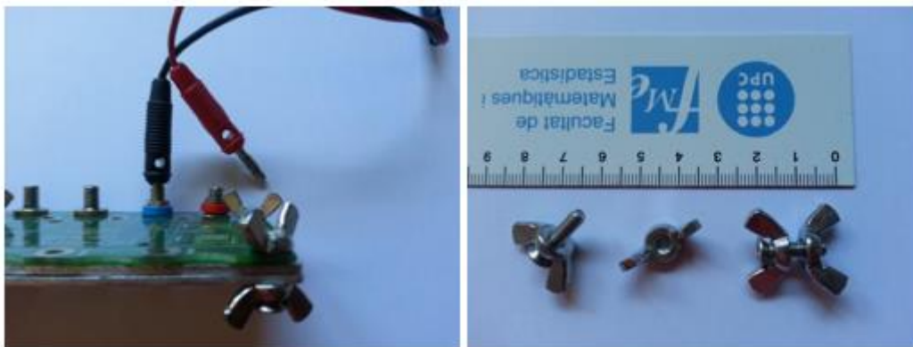
Fig. 8.14: Fotos de detalle de unión tornillo-palomilla.
