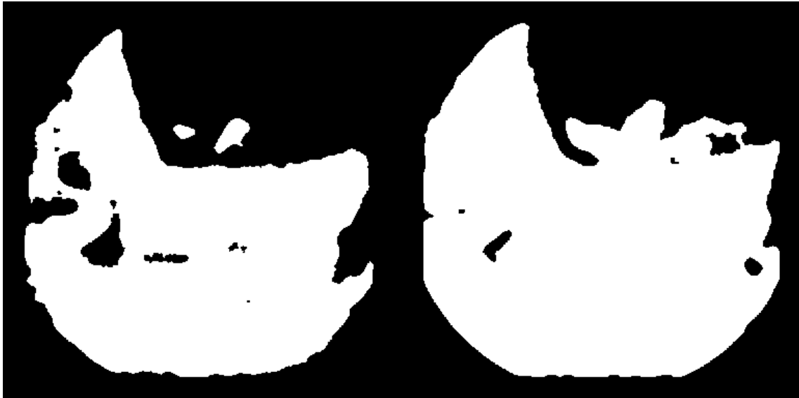
Figura 23: D'esquerre a dreta: Imatge binaritzada amb el mètode Otsu, imatge binaritzada disminuint el valor del llindar obtingut pel mètode Otsu amb la constant 1.42.
