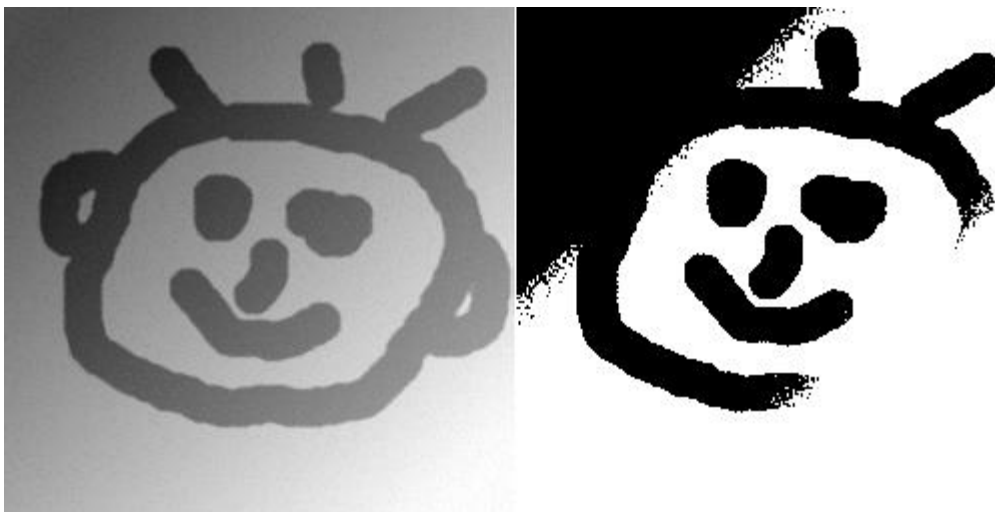
Figura 23: Imatge amb mala lluminositat binaritzada utilitzant el mètode de Otsu.
