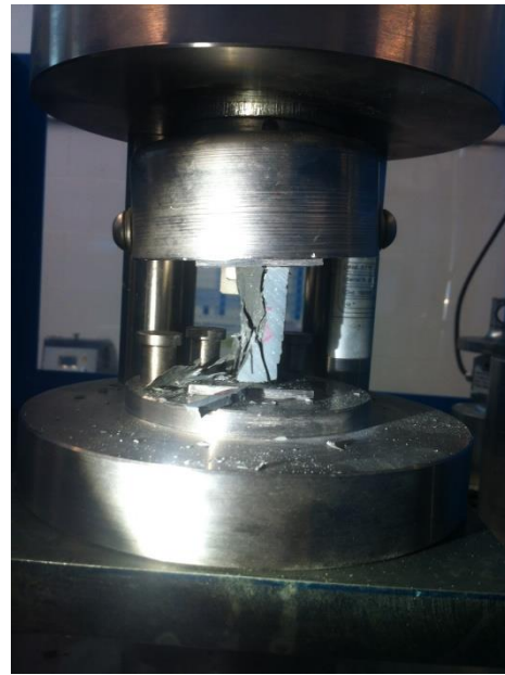
Figura 12. Final de l'assaig de compressió
