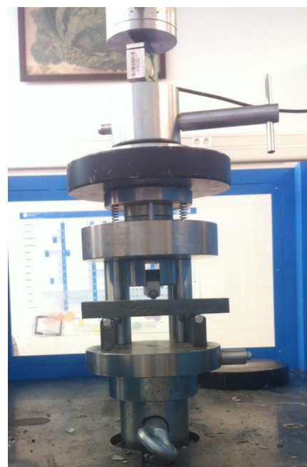
Figura 11. Maquinaria per la realització del assaig de flexió
