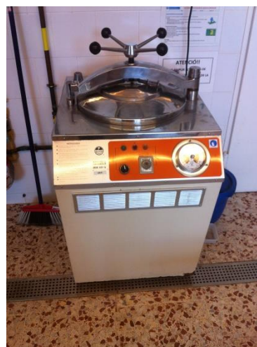
Figura 21. Autoclaui, utilitzat pel tractament de les fibres
