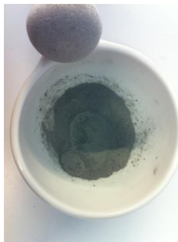
Figura 15. Moltura del ciment fins obtenció de pols
