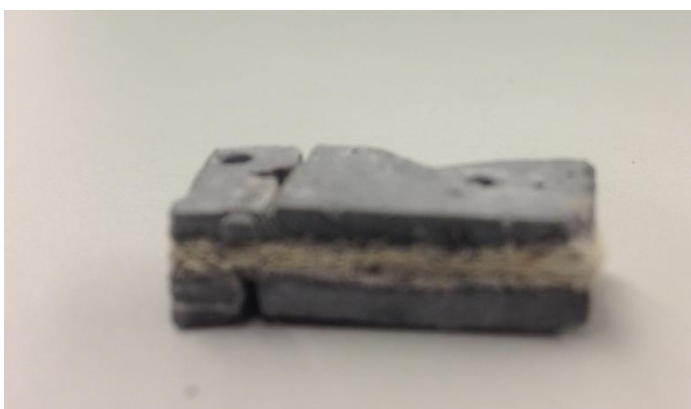
Figura 23. Proveta de fibrociment talla pel posterior anàlisi de tracció
