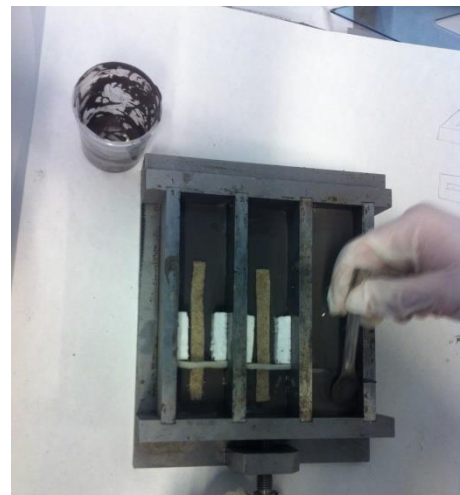
Figura 22. Preparació en el motlle del fibrociment
