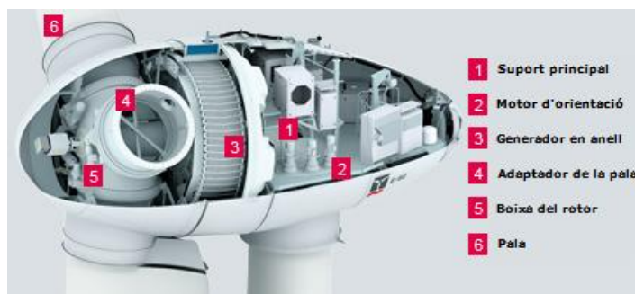
Figura 1. Parts de la góndola d'un aerogenerador marca Enercon E82.
