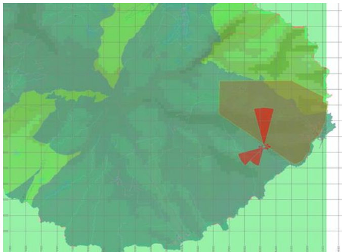
Figura 16. En marró, exemple de la zona delimitada per a ubicar-hi els aerogeneradors a Openwind®.
