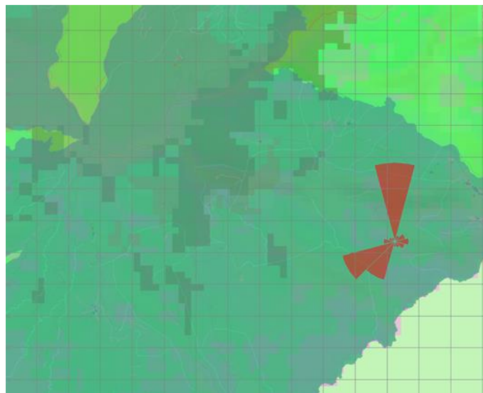
Figura 15. Amb vermell, distribució freqüencial del vent generada per a La Gomera a Openwind®.
