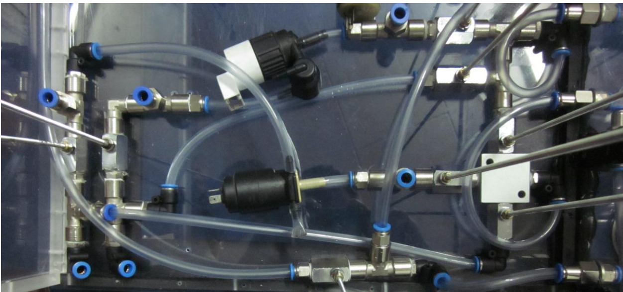
Figura 9 - Circuito de carga y descarga de líquido en la cámara de bombas.
