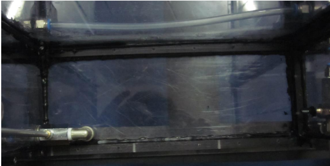
Figura 11 - Tanque de agua de lastre de estribo.
