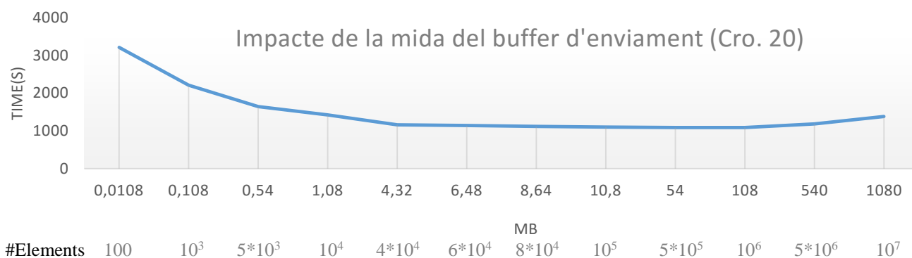
Il·lustració 23: Temps d'execució en funció de la mida del buffer d'enviament
