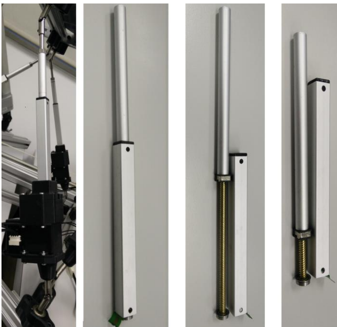
Fig 6.2. Exemple d'una pota prismàtica on un vis sens fi s'enrosca entorn una femella per augmentar o disminuir a longitud de la pota.
