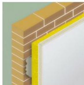
Figura 9: d'aïllament tèrmic interior. Font: www.instalacionesyeficienciaenergetica.com
