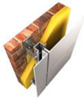
Figura 7: : Sistema de façana ventilada. Font: www.instalacionesyeficienciaenergetica.com
