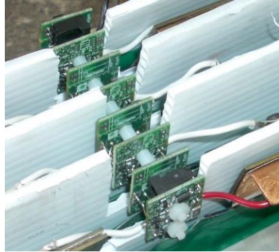
Figura 5.4 Connexió de la Slave proposada per Elithion. [7]
