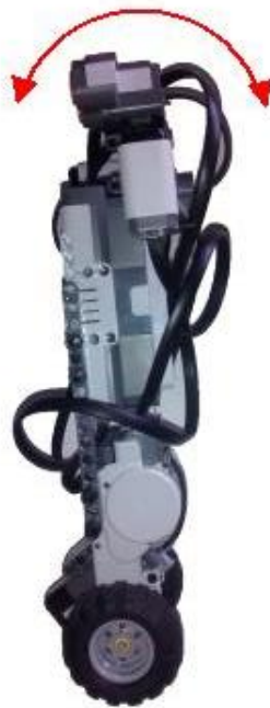
Figura 24: Eje de medida del sensor giroscópico II.
