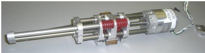
Figura 3.3 Ejemplo de actuador elástico en serie [23].
