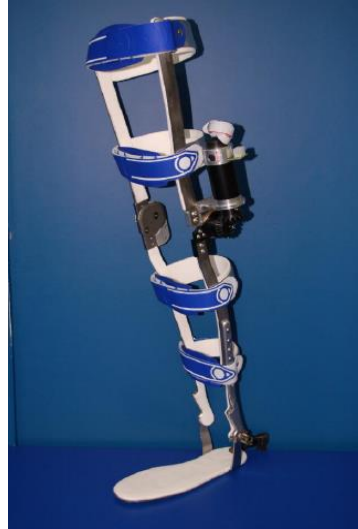
Figura 3.1 Prototipo de ortesis activa en la rodilla (segundo modelo construido por el Departamento de Mecánica de la ETSEIB).
