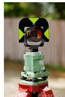
Imagen 1.7: Conjunto de trípode, base nivelante y prisma circular. Leica Geosystems.
