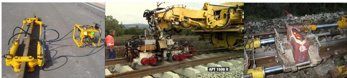
Imagen 1.42: Aparatos de corte de soldadura y de esmerilado de vía. Tecsma empresa constructora.
