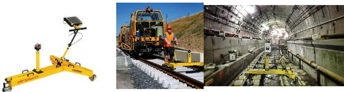
Imagen 1.9: Carro auscultador de via Leica GRP System FX.
