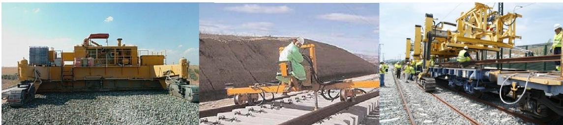
Imagen 1.28: Extendedora de balasto. Posicionadora de carril. Tren de trabajos. Tecsra empresa constructora.
