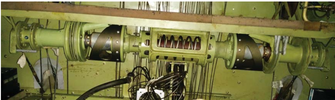
Fig. 1.9 Barra de torque del sistema de alerones
