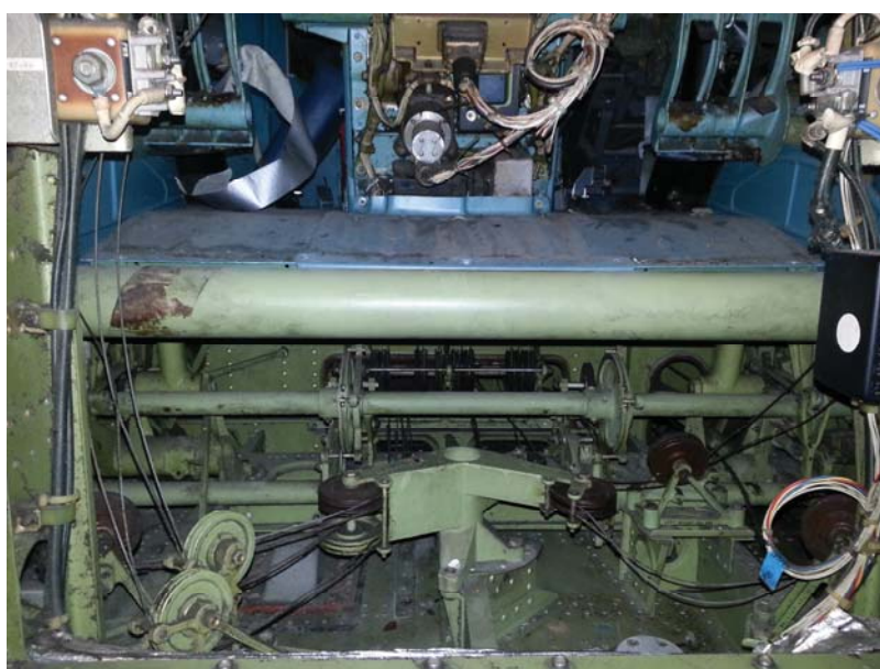
Fig. 1.12 Vista trasera del pedestal de cabina y del sistema de pedales
