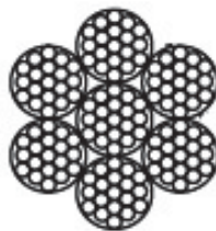
Cable trenzado mandos de vuelo 7x19 Figura 2
