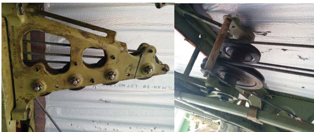
Fig. 3.2 Estructuras con poleas reutilizadas
