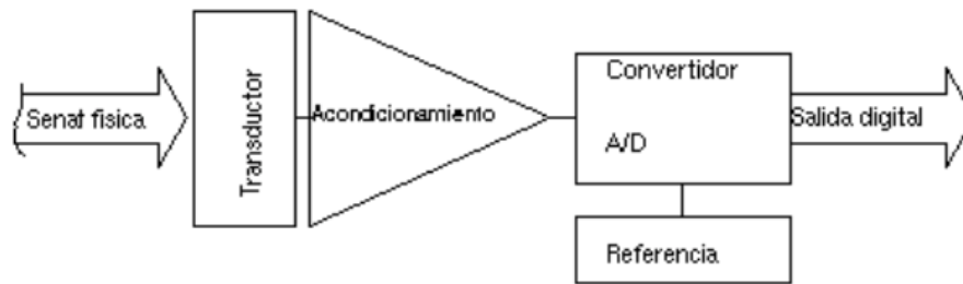
Figura 5.1. Diagrama de bloques de un sistema de adquisición de datos (Juan Antonio Rubia Mena 2010).
